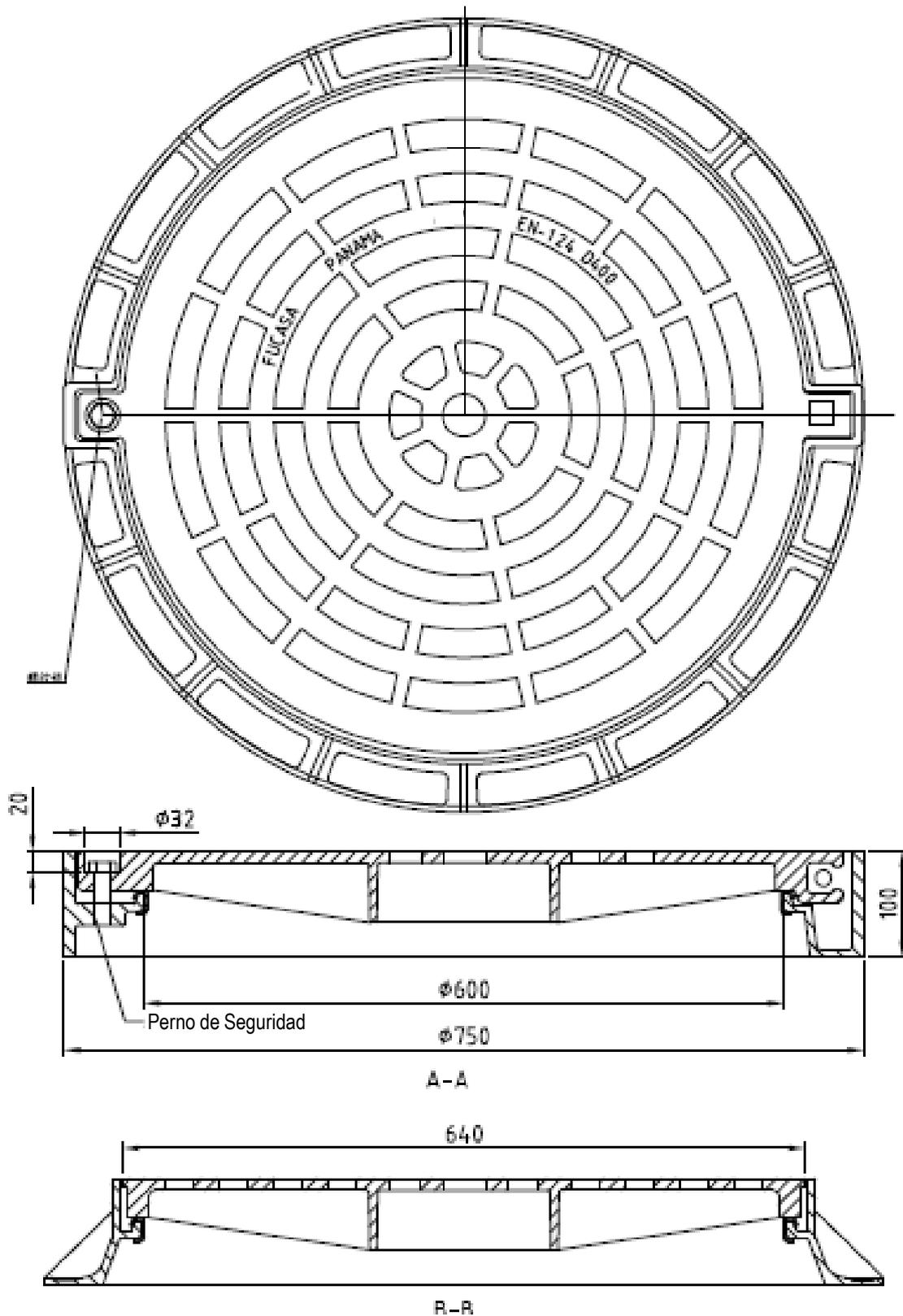
Material: Fundición de hierro dúctil grafito esférico
